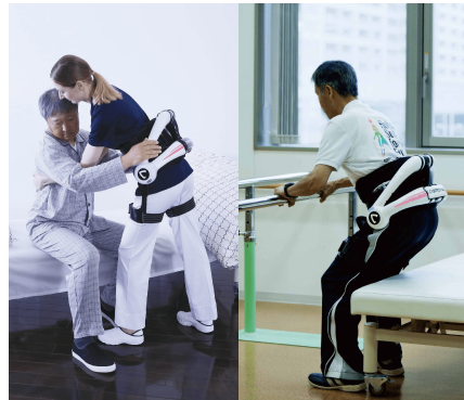
介護用途と自立支援用途の二つの用途で使える、新しいHAL腰タイプ
