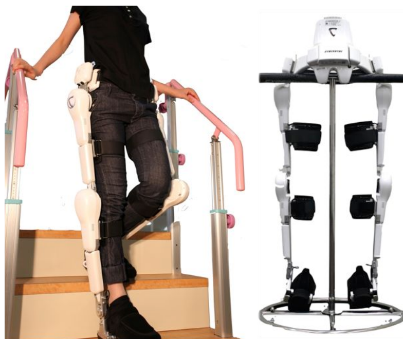
世界初の ISO/DIS 13482 認証を取得するロボットスーツ HAL ® 福祉用
