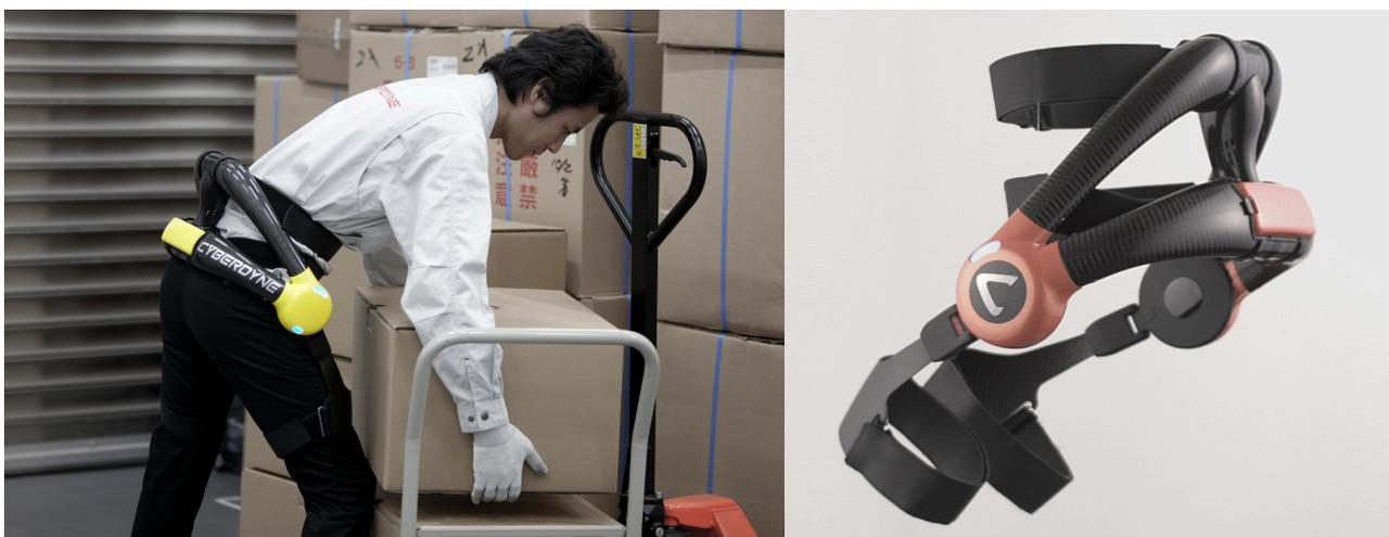
作業向け装着型ロボットとして世界初の CE マークが表示される『HAL<sup>®</sup>作業支援用(腰タイプ)』
